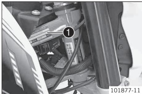
Табличка с типом ТС ❶ выбита справа от рамы перед рулевой колонкой.
