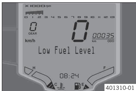
При падении уровня топлива до отметки резерва на информационном дисплее появляется сообщение **Low Fuel Level** (Низкий уровень топлива).
