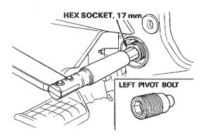
Install the pivot lock nut on the pivot bolt.
