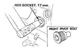
Tighten the left pivot bolt.
