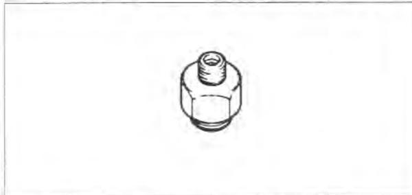
Valve Seat Cutter, 60° -  $\phi 25$  : 57001-1328
