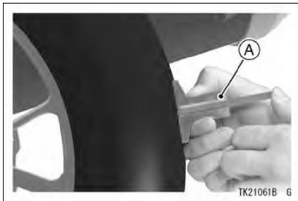
**A.** Измерение глубины протектора щупом
