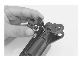
Apply SUZUKI SUPER GREASE to the brake lever pivot bolt.
