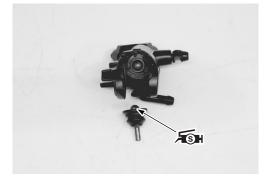
• Apply SUZUKI SILICONE GREASE to the brake lever pivot bolt.
