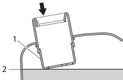
1. Заливная горловина топливного бака
