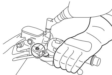
Оси качания рычагов переднего и заднего тормоза подлежат смазке в указанные в таблице периодического обслуживания и смазки интервалы.
