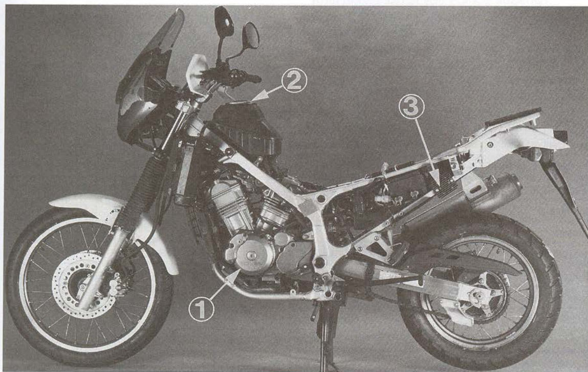
Изображение 2 Боковое представление слева 1 генератор 2 фильтра для очистки воздуха 3 Реле регулятора / выпрямителя
