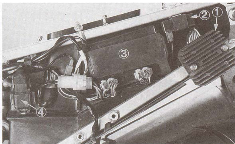
Изображение 75. Конструктивные элементы электрики при снятие левой боковины. 1 реле стабилизатора 2 реле блинкера 3 Блок зажигания 4 реле стартера
